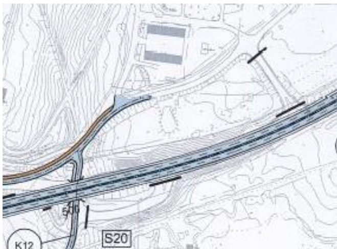
Vasemmanpuoleinen kuva: ote vuoden 2023 tiesuunnitelmakartasta vt 4 ja vt9 parantaminen välillä Kanavuori-Haapalahti (3T-5: V9 plv 280-2220, Revisio A). Oikeanpuoleinen kuva: ote vuonna 2015 laaditusta aluevaraussuunnitelmasta. Metsälehmuskentien ja Varikkotien risteys sekä vt9:n linjaus ovat eri tavoin ratkaistu.
